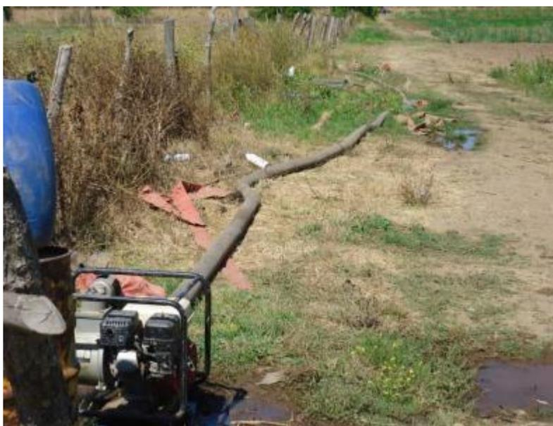
**Aspectos de sistemas de riego utilizado actualmente en el sector, usando como recurso el agua de pozo profundo o punteras hídricas**
